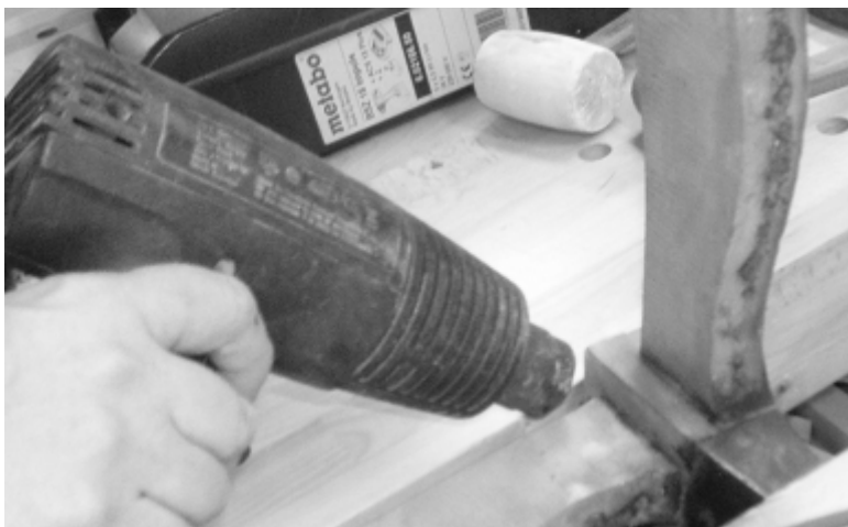
Liimliite kuumutamine fööniga
