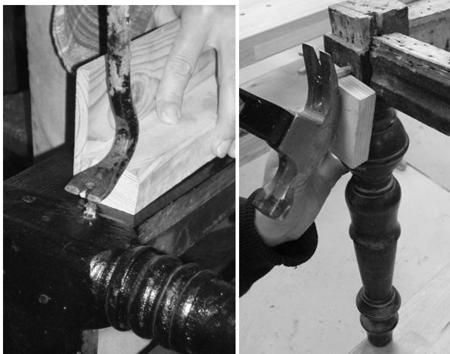
Puitnaelte (naaglite) eemaldamine sissekeeratud kruviga
