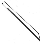
Joon. 77. Hõövliraua lõige. Tööriistaterasest on ainult raua eespiind. Raud ise on pehmest karastamata terasest (rauast).
