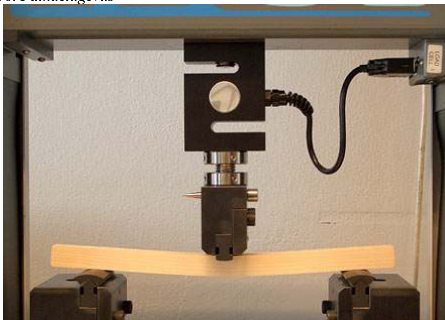
Joonis 59. Paindetugevuse määramine laboris
