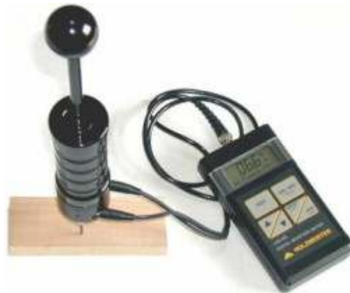
Joonis 41. Elektrilise takistuse põhimõttel töötav niiskuse mõõtja.
