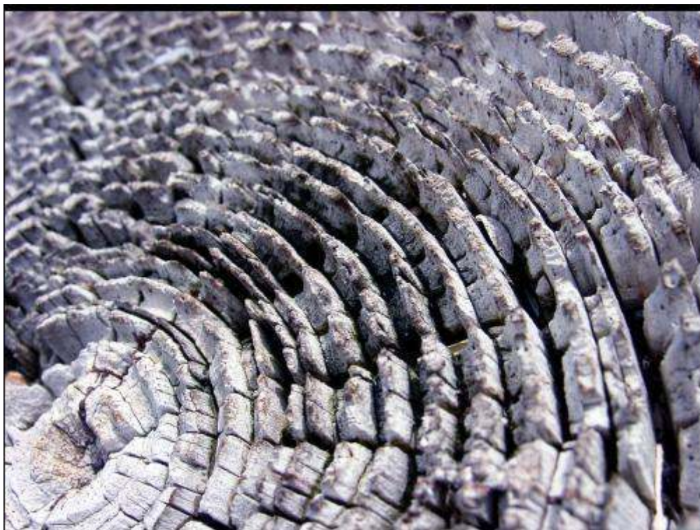
Joonis 54. Puidu struktuuri kahjustused ultraviolettkiirguse toimel
